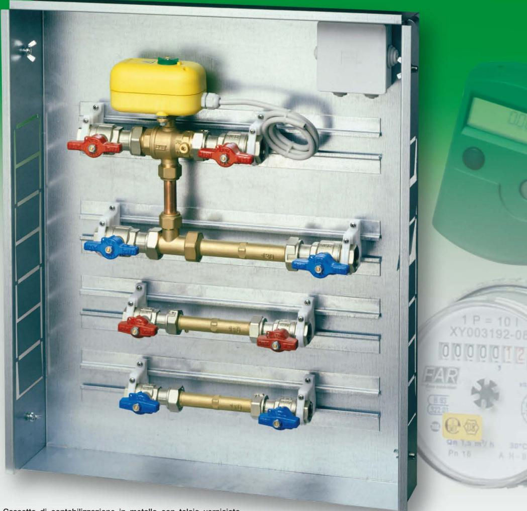
Cassetta di contabilizzazione in metallo con telaio verniciato, premontata, disponibile con valvola di zona a 2 o 3 vie con bypass. Predisposta per l'installazione di calorimetro/frigorimetro e di contatori per acqua calda e fredda sanitaria. Completo di valvole di intercettazione del fluido, tronchetto per prova impianto e pozzetto porta sonda. Le dimensioni disponibili sono: 1/2" e 3/4".
