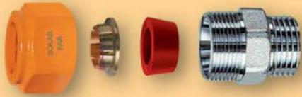
FAR presenta la nuova serie di raccordi per impianti solari termici. I raccordi realizzati in ottone cromato e le tenute in gomma anticalore. Sono installabili fino a temperature di 160°C. Adatti per il collegamento di tubazioni in rame e acciaio.
