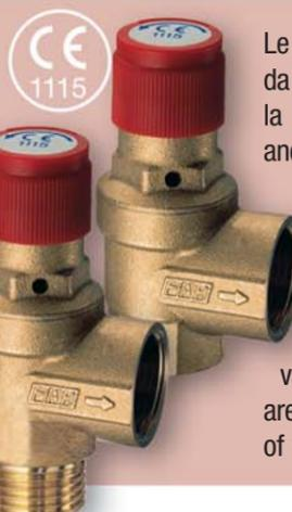
Le valvole di sicurezza sono disponibili in un'ampia gamma di tarature, da 1 bar fino a 10 bar. Il corpo è realizzato completamente in ottone con la molla di taratura in acciaio inossidabile. Le valvole sono disponibili anche nella versione per impiego su impianti solari termici. Le versioni sono con attacchi maschio-femmina, femmina-femmina. Tutte le valvole di sicurezza sono qualificate PED.
