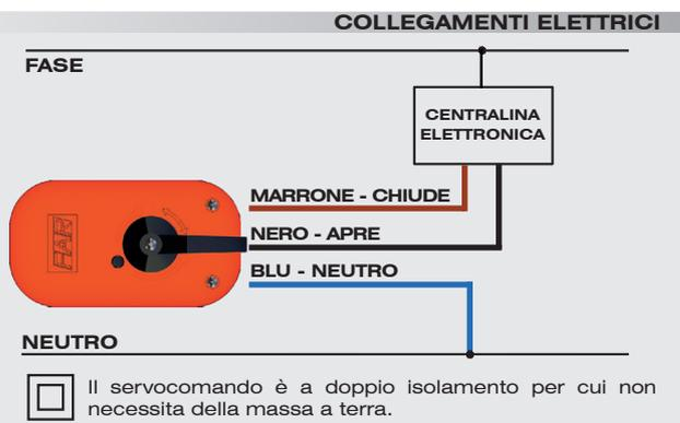
Per comandare l'apertura e la chiusura della valvola di zona per mezzo del servocomando, basta collegare il cavo di colore blu al neutro dell'alimentazione, il cavo di colore marrone ed il cavo di colore nero alla centralina climatica. Con presenza di fase sul cavo nero la valvola va in apertura, mentre con fase sul cavo marrone il motore va in chiusura.
