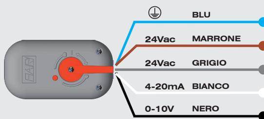
Per comandare l'apertura e la chiusura della valvola di zona per mezzo del servocomando, basta collegare il cavo di colore blu al neutro, il cavo di colore marrone alla fase ed il cavo di colore nero alla centralina di comando 0-10V (oppure il cavo bianco se la regolazione è 4-20mA). Il cavo di colore grigio serve invece per invertire il punto di partenza del motore, si consiglia, per le nostre applicazioni, di lasciarlo sempre sotto tensione.
