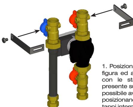
1. Posizionare le staffe come in figura ed avvitare le viti (fornite con le staffe) sul tappo già presente sulla valvola a sfera. E' possibile avvitare le staffe anche posizionandole in prossimità dei tappi interni delle valvole a sfera.
