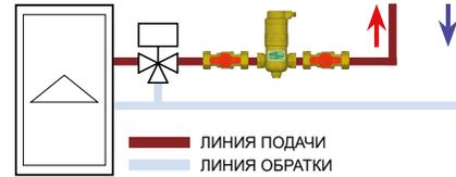
**⚠ Для систем охлаждения деаэратор следует устанавливать на обратном трубопроводе.**
