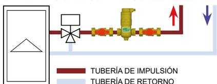
**⚠ En las instalaciones de resfriamiento es conveniente instalarlo en la tubería de retorno.**
