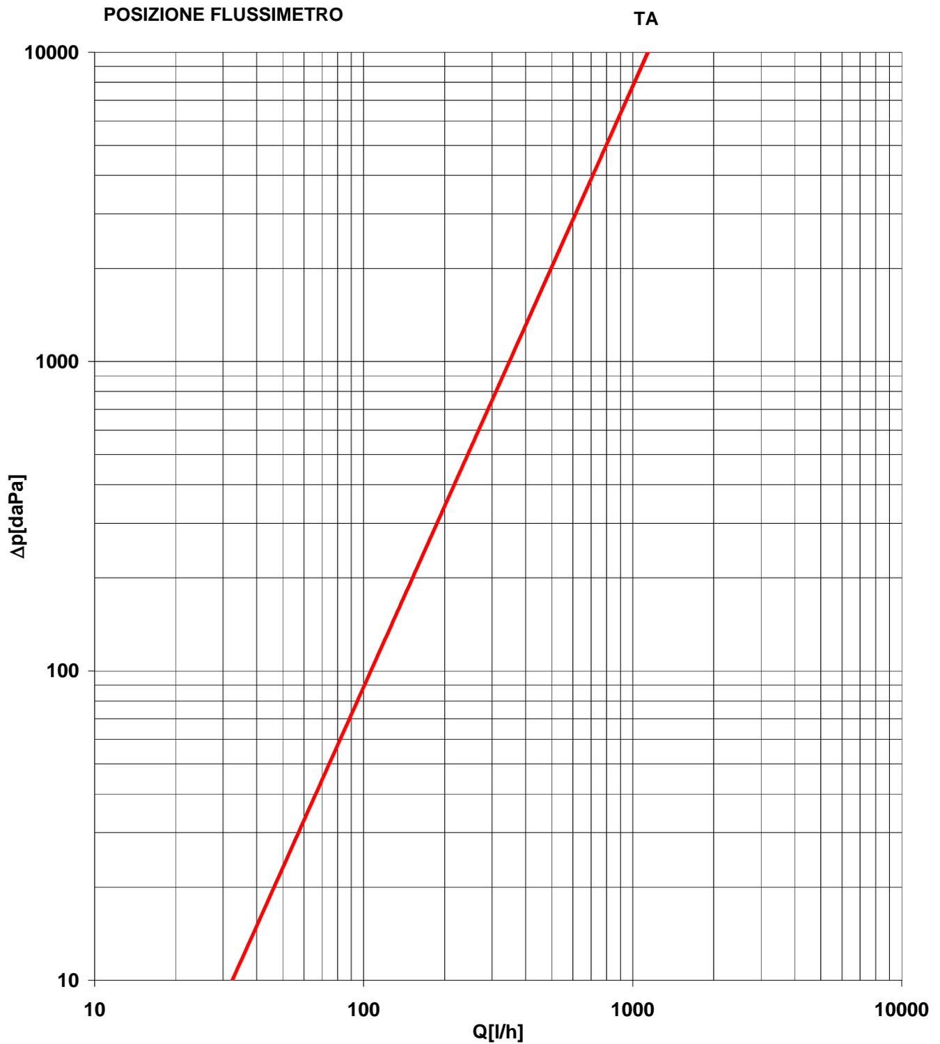
PERDITE DI CARICO DELLA DERIVAZIONE CON FLUSSIMETRO CON APERTURA MASSIMA
